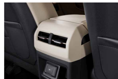
Otvori za ventilaciju pozadi
