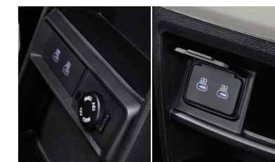
Priključci USB Type-C (Napred: 1 za punjenje, 1 za podatke i punjenje / pozadi: 2 za punjenje)
