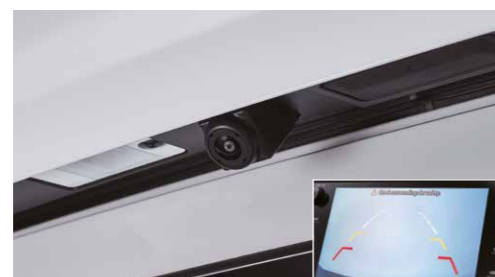
Zadnja kamera i monitor
