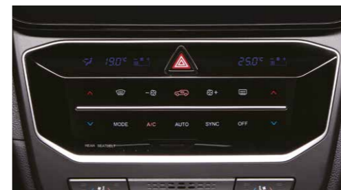
Sistem klimatizacije sa dvostrukom prednjom zonom
