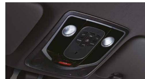
Konzola na svodu sa praktičnim osvetljenjem i prekidačem za kontrolu krovnog prozora
