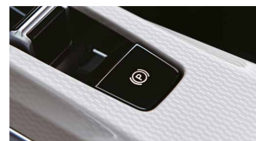
Elektronska parkirna kočnica sa funkcijom automatskog zadržavanja
